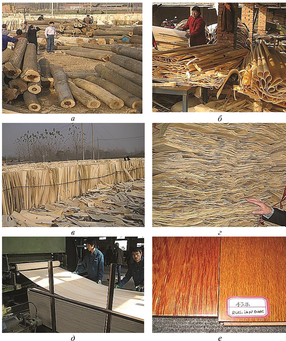
Рис. 2. Изготовление фанеры и мебельных плит из тополя: a – разгрузка тополевых бревен; б – получение шпона; в – сушка шпона; г – складирование шпона; д – изготовление фанеры; е – мебельные фанерные плиты из тополя, облицованные дубовым шпоном (КНР, ноябрь 2008; фото А.П. Царева)
